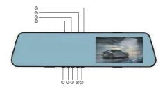
1, M键 2,上键 3,电源键 4,下翻 5 OK键 6, USB接口 7,后拉摄像头接口 8,TF卡槽 9.复位键
