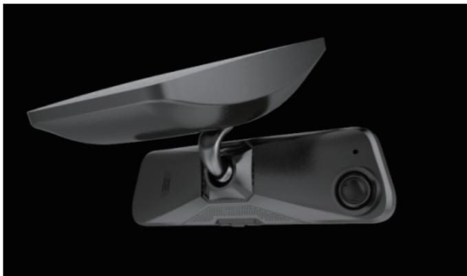
1. 9M身高的驾驶人员调试座位和流媒体镜面与眼睛视野水平位置对齐，再调节前摄像头角度为右偏下15° (注：调试人员在车外透过挡风玻璃所看到的前摄像头水平偏移角度)， 如下图：
