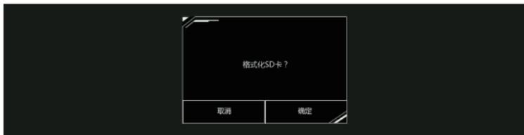
点击【确定】则格式化SD卡，点击【取消】则取消格式化SD卡；
