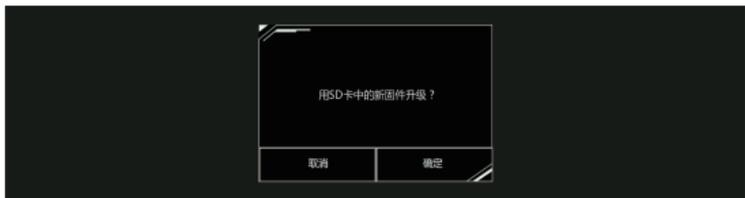
点击【确定】则用SD卡中的新固件升级，点击【取消】则取消用SD卡中的新固件升级；
